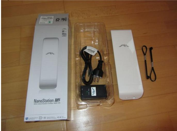
Je nach Lieferant liegt dem Paket ein Netzanschlusskabel mit Deutschem Schukostecker oder mit Schweizer T12 Stecker bei. Auf der Geräteseite wird der bei uns eher weniger gebräuchliche Micky-Mouse oder Kleeblatt Stecker Typ C6 verwendet.
