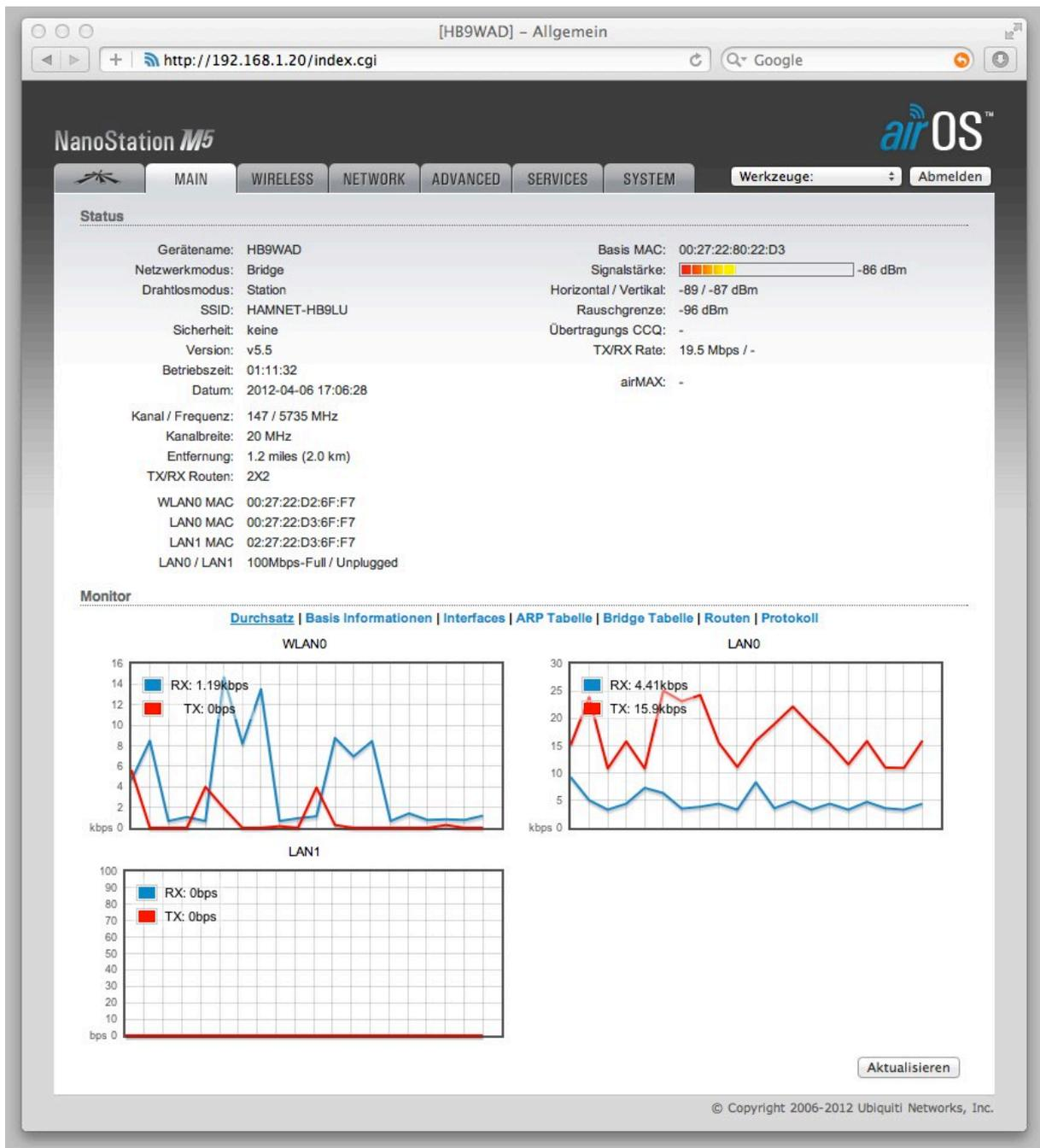
Wenn im Tab ‚Network‘ nichts verändert wurde, dann läuft die Nanostation nach wie vor als Bridge. D.h. Alle Datenpakete die auf dem WLAN empfangen werden, werden unverändert auf dem Ethernet LAN ausgesendet und umgekehrt. Diese Betriebsart ist geeignet um einen einzelnen Computer ohne andere Verbindung mit dem Hamnet zu verbinden. Die Ethernet Schnittstelle am Computer wird jetzt auf DHCP umgestellt und der Computer bekommt vom Hamnet Router eine IP Adresse zugeteilt:
