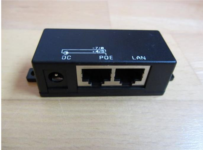
In keinem Datenblatt zur Nanostation wird eine minimale Versorgungsspannung erwähnt, nur die maximale Versorgungsspannung von 24V. Die Praxis hat aber gezeigt, dass ab ca. 10V ein zuverlässiger Betrieb möglich ist.
