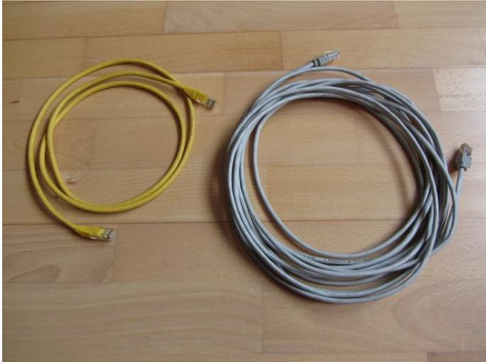
Fastethernet verwendet nur vier der 8 Pins auf dem RJ45 Stecker für die Datenkommunikation. Es sind dies die Pins 1,2,3 und 6. Erst Gigabit Ethernet verwendet alle 8 Pins. Bei der Nanostation werden die vier für die Datenkommunikation unbenutzten Pins 4,5,7 und 8 für die Spannungsversorgung der Elektronik verwendet. Zwischen dem PoE Injektor und der Nanostation muss also zwingend ein Patchkabel mit 8 Adern verwendet werden.
