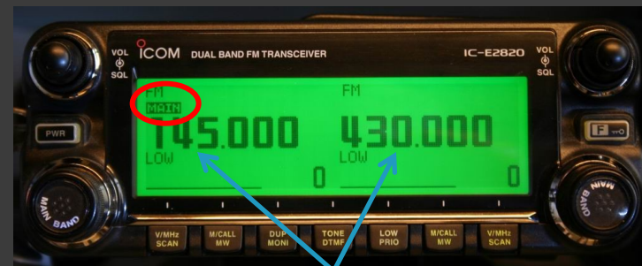
Zwei VFO sind zu sehen. Der PTT aktive wird mit MAIN bezeichnet.
