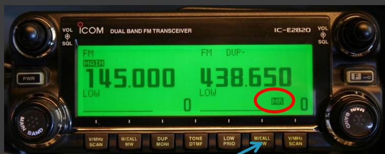
TRX in Memory-Modus setzen (VFO R)
