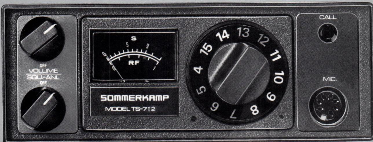
**2 Watt 12 Kanal Sendeempfänger für Mobilbetrieb**
