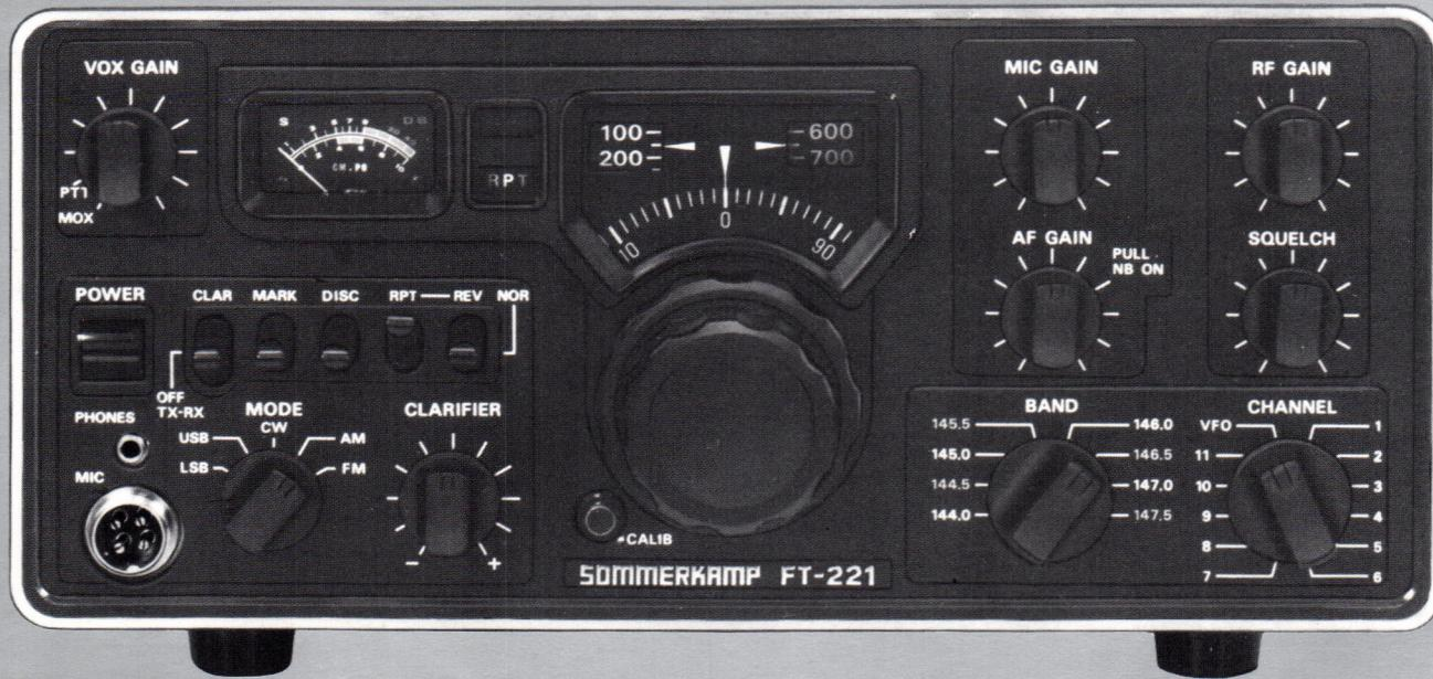
Ein 2 m-Sendeempfänger für SSB, CW, AM und FM
