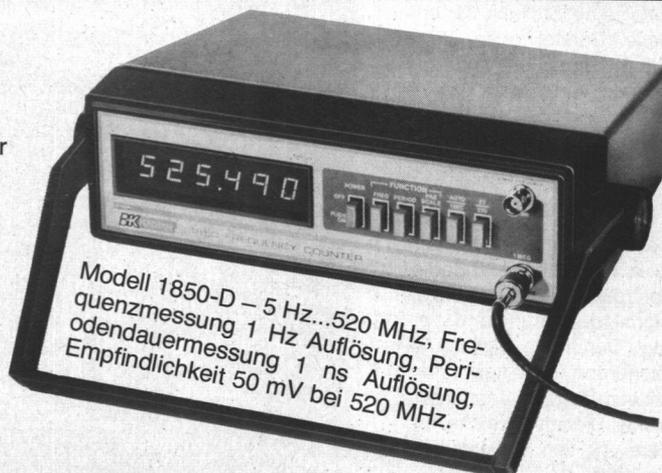
Modell 1850-D - 5 Hz...520 MHz, Frequenzmessung 1 Hz Auflösung, Periodendauermessung 1 ns Auflösung, Empfindlichkeit 50 mV bei 520 MHz.
