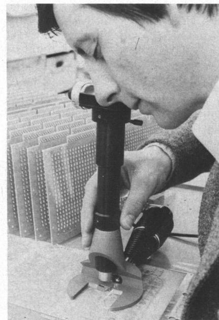
Mit dem Unterätzungs-Meßmikroskop lassen sich das Ausmaß und die Form von Unterätzungen schnell und zerstörungsfrei bestimmen
