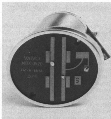
Bild 1. X-Band-Doppler-Radar-Modul MDX 0520, eine kompakte SHF-Sende-Empfangseinheit mit Flachantenne
