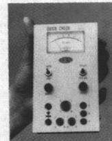
Spannungsversorgung: 3x 1,5 V-Batterie
