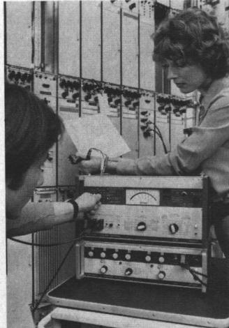
kann die bewertete und unbewertete Störspannung gemessen werden. In der Meßart „Pegel“ lassen sich die geforderten Dämpfungswerte einer Übertragungsstrecke sowie Pegel an Zwei- und Vierpolen messen. Zum Registrieren der Meßergebnisse sind zwei Ausgänge vorhanden. (Siemens, Postfach 103, 8000 München 1)
