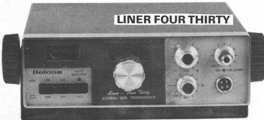
Der Belcom-Liner-Four-Thirty ist ein 432 MHz Amateur SSB-Transceiver. Das Gerät ist voll-bequartzt. Eine raffinierte Schaltung überwacht den gewählten Kanal. Die Empfangsfrequenz wird im Kanalbereich geswept (über 20 KHz) sodass eine Station zu erkennen ist wenschon ihre Frequenz von der des Empfängers abweicht.
