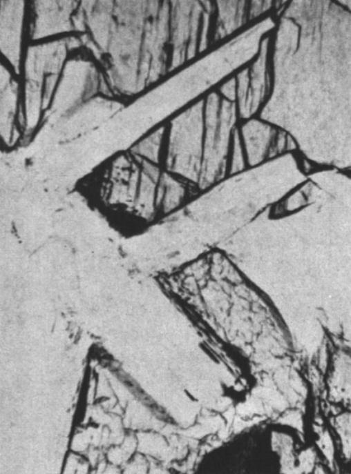
*Links oben: Grobkörniger Basalt im Dünnschliff. Die Minerale Plagioklas (links, mit Ausstrahlungen nach rechts oben), Pyroxen (oben, gefurcht) und Cristobalit (schuppig) zeigen ein typisches Verwachsungsgefüge.*
