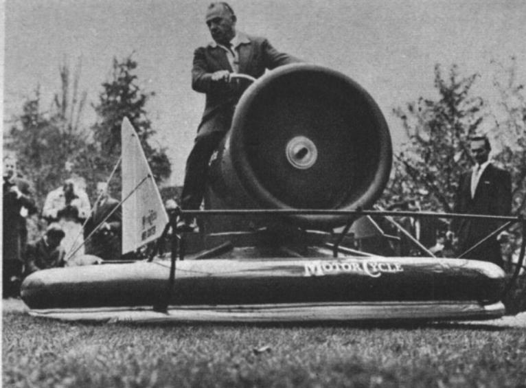
Fahrzeuge nicht zu breit gebaut werden müssen und der Luftwiderstand bei hohen Geschwindigkeiten nicht zu gross ist, wird die ovale oder rechteckige Form bevorzugt. Eine Schwebhöhe, die etwa einem Zehntel des Fahrzeugdurchmessers entspricht, ergibt das günstigste Gleichgewicht.
