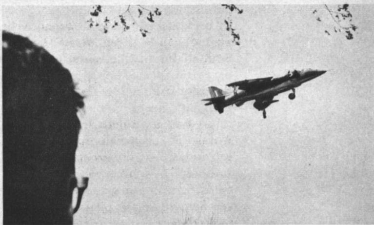
Auf der kleinen Fläche von dreihundert Quadratmeter ist der «Harrier» gelandet. Am Schwanzende rechts ist eine der Steuerdüsen sehr gut sichtbar. Die Antriebsdüsen unter den Flügeln sind gegenwärtig nach hinten gerichtet.
