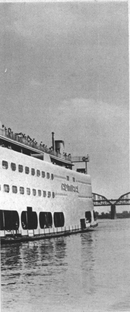
Solche Heckraddampfer — und zwar in neuester Zeit gebaut — findet man beispielsweise auch auf dem Amazonas, dem mächtigsten Strom Südamerikas. Offenbar besitzen diese flach gebauten Schiffe mit dem geringen Tiefgang (auch das Heckrad taucht nicht tief ein) für die Schifffahrt auf Flüssen, die stellenweise nur eine geringe Tiefe aufweisen, manchen Vorteil.
