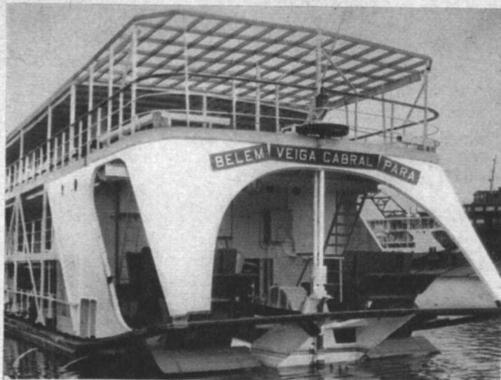
**Ansicht des Hecks eines modernen Passagier-Flußschiffes. In dieses und in weitere fünf Schiffe der gleichen Art baute die Schweizerische Lokomotiv- und Maschinenfabrik Winterthur die zweistufigen Reduktionsgetriebe für Heckradantrieb ein. Diese übertragen die Leistung des in der Schiffslängsachse aufgestellten Dieselmotors auf die im Heck querliegende Schaufelwelle.**
