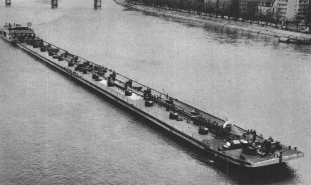
Oben sehen wir zwei hintereinandergekoppelte Tank-Leichter, die von einem Schubboot gestoßen werden. Ein solcher Leichter ist 72 m lang, 11 m breit und hat bei voller Belastung einen Tiefgang von 2,7 m.
