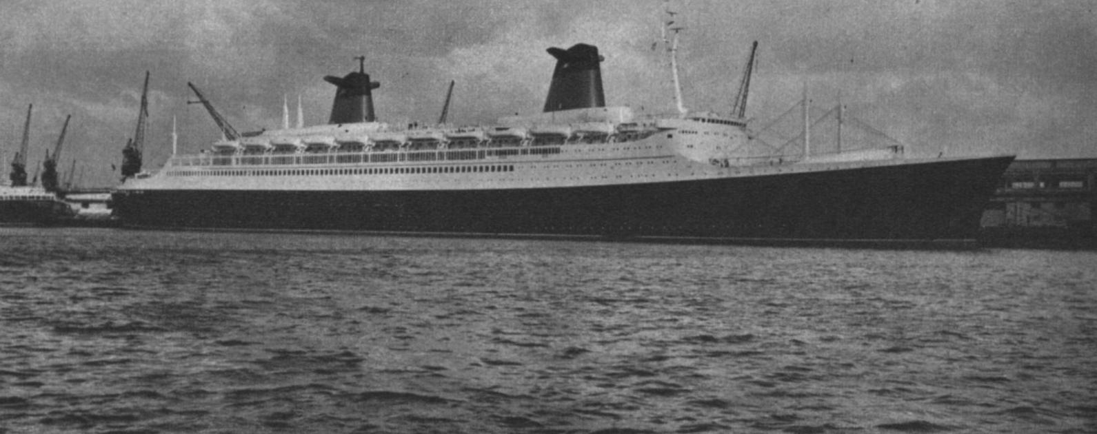
*Der neue französische Luxus-Passagierdampfer „La France“ ist 315,7 m lang und 33,7 m breit. Er bietet Raum für 2044 Passagiere und 1000 Personen Besatzung. Jede der 4 großen Schiffsschrauben wiegt 27 Tonnen und leistet in der Minute 162 Umdrehungen. Das Schiff kann mit einer Geschwindigkeit von 34 Knoten (à 1852 m), also mit rund 63 km pro Stunde fahren. Es besorgt den Passagierverkehr zwischen Le Havre und New York. Dauer einer Überfahrt 5 Tage.*
