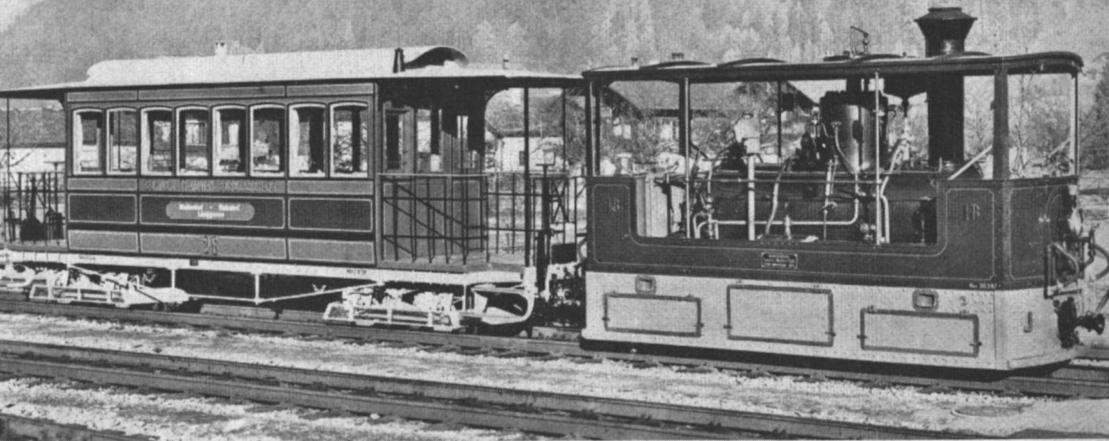
**Schmalspurige Straßenbahn-Lokomotive mit Anhänger der Berner Tramway-Gesellschaft aus dem Jahre 1894. Dienstgewicht 16 Tonnen. Höchstgeschwindigkeit 25 Stundenkilometer. Interessant, wie man die Lokomotive gleichsam in einen Tramwagen ‚verkleidet‘ hat, aus dessen Dach ein Stück des Kamins herauschaut. – Das Verkehrshaus der Schweiz bietet eine reiche Fülle des Interessanten aus allen Gebieten des Verkehrs in Vergangenheit und Gegenwart.**
