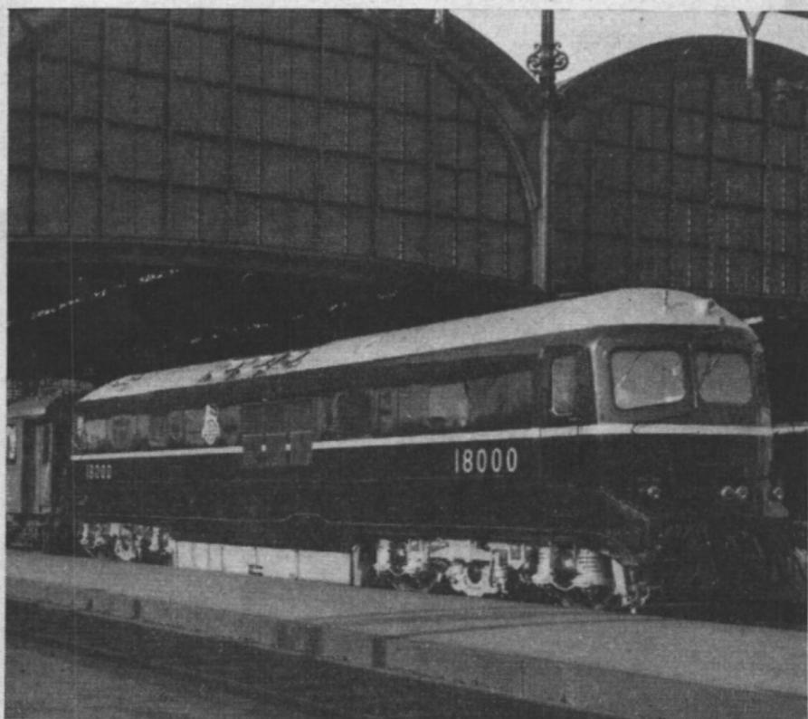
**Die erste Gasturbinen-Lokomotive der Welt bei ihrer Probefahrt auf der Strecke Luzern-Basel.** — Die Maschine wiegt 117 Tonnen, besitzt 2500 PS und fährt mit einer Stundengeschwindigkeit von 130 km. Sie wurde von der AG Brown Boveri & Cie., in Baden, für die Britischen Bahnen gebaut und verkehrt auf der Strecke London-Birmingham-Swansea. Der mechanische Teil der Maschine stammt von der Lokomotivenfabrik Winterthur.
