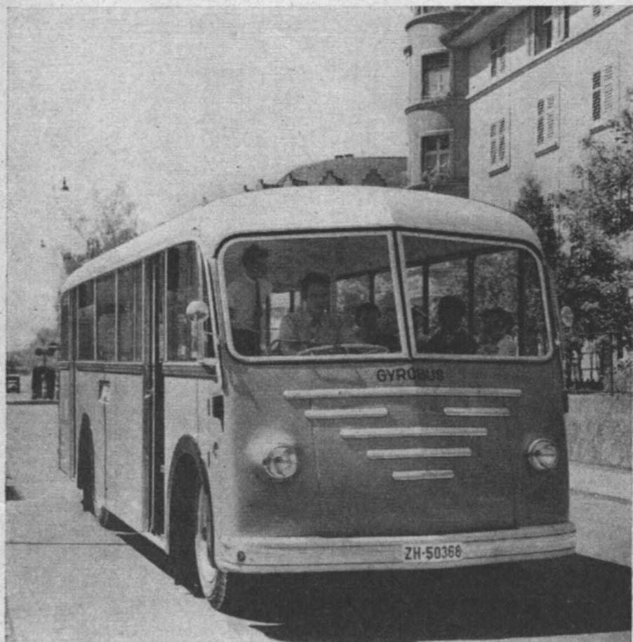
**Der erste Gyrobus auf der Fahrt.** Er wird von einem Schwungrad in Bewegung gebracht und kann 6—7 km weit fahren. An den Endstationen wird das Schwungrad durch elektr. Kraft für eine weitere Fahrt von 6—7 km wieder in Umdrehung gebracht. So fährt der Gyrobus ohne Oberleitung und ohne Akkumulatorenbatterien dennoch elektrisch. (Im Artikel ist ausführlich beschrieben, wie der Betrieb vor sich geht.) Dieser Elektro-Gyro ist für Strassen- und Schienenfahrzeuge verwendbar.
