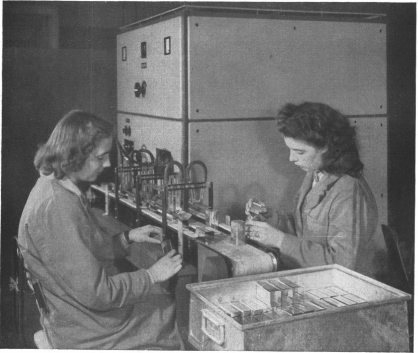
Abb. 18-14. Verlöten von Kondensatorbechern mit Hochfrequenz (Werkbild: *Elektro Spezial GmbH*)
