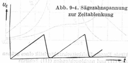
Abb. 9-4. Sägezahnspannung zur Zeitablenkung
