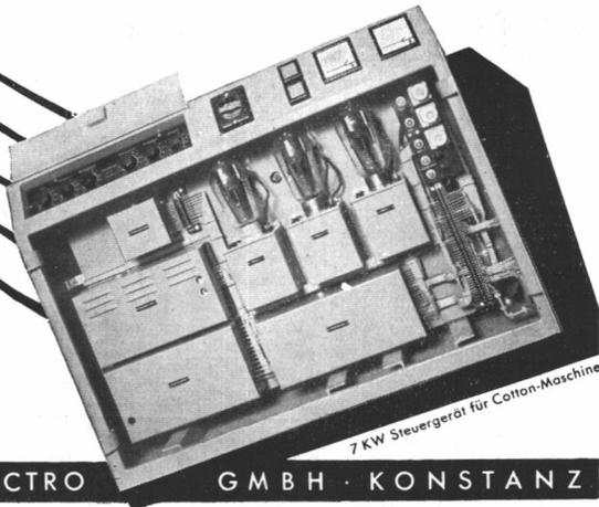
7 KW Steuergerät für Cotton-Maschine
