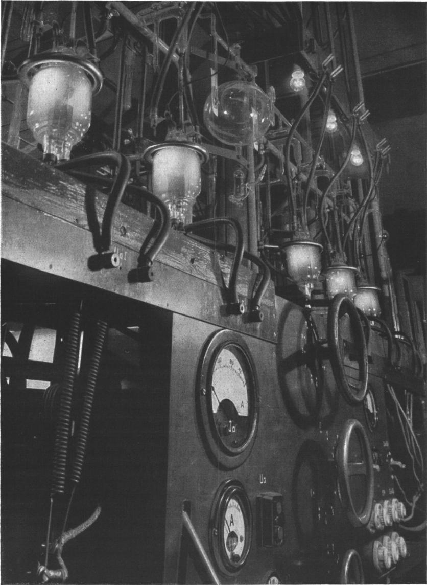
Abb. 2-16. Hochstrom-Gleichrichterröhren auf dem Pumpstand (Werkbild: Deutsche Philips GmbH)
