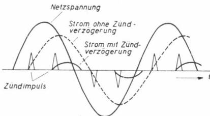
Abb. 4-8. Verlauf von Strom und Spannung bei verzögerter Zündung
