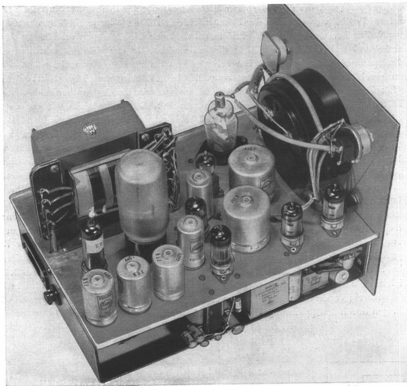
Abb. 20-9. Chassis-Ansicht des fotoelektrischen Drehzahlmessers
