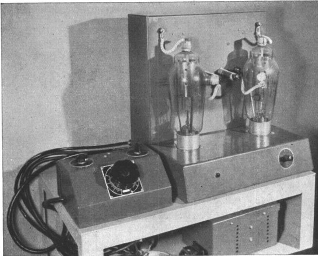
Abb. 14-9. Laborausführung eines Helligkeitsregelgeräts für Leuchtstofflampen
