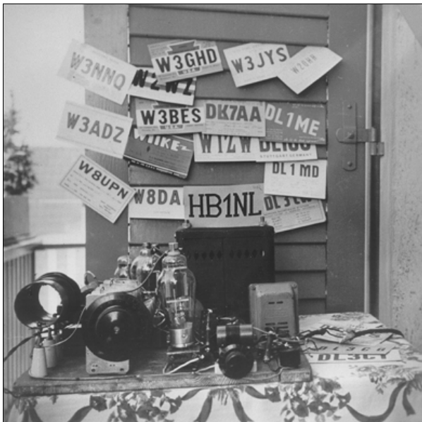
PA-Kreis, T50, 8005, HV-Trafo, Heiztrafo, Kristalexiter
