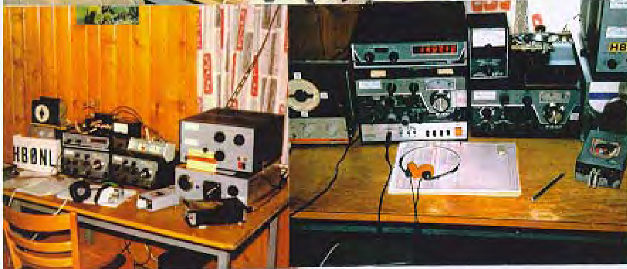
Eigenbau-PA mit 3-400, SSTV, Drake C-Line mit L-4B, Matchbox
