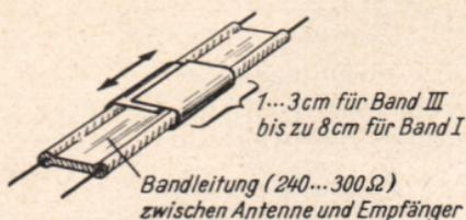
Bild 68. Kapazitiver Schieber aus dünnem Blech als einfachstes Mittel zur teilweisen Kompensation störender Blindkomponenten
