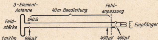
Bild 75. Beispiel für den Pegelplan einer Antennenanlage ohne Verstärker (hierzu Bild 74 und Tabelle 13). Der mit Fehlanpassung bezeichnete Spannungssprung berücksichtigt zugleich Verluste durch Feldstärkeschwankungen und Witterungseinflüsse
