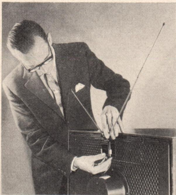
*Bild 83. Teleskop-Heimantenne für Nahfeldempfang
