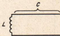
Bild 3. Die Leitung als geöffneter Schwingungskreis
