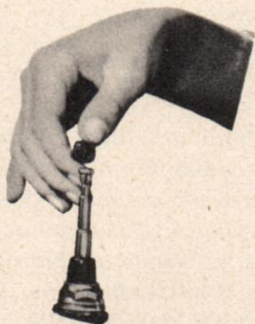
Oben: Bild 96. Auto-Versenkantenne, die nach Abnehmen des Stülpknopfes zur Schlüsselantenne wird (Hirschmann)
