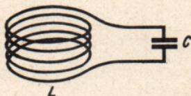
Bild 2. Der geschlossene Schwingungskreis mit großflächiger Spule (Rahmenantenne)
